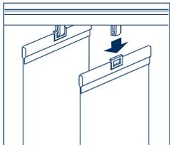
Zunächst Kette + Beschwerungsplatten entfernen. Lamellen auf 90° (rechtwinklig) mit der Spitze des Widerhakens nach vorn ausrichten. Lamelle nach hinten abwinkeln und runterziehen.
