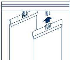
Laufhaken rechtwinklig ausrichten. Lamellen von unten einklippen.
